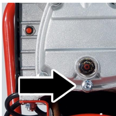
Модель AIR. Сливной болт под смотровым окошком, размер 10.
